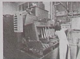
↑ 洗浄機を分解して清掃している様子
